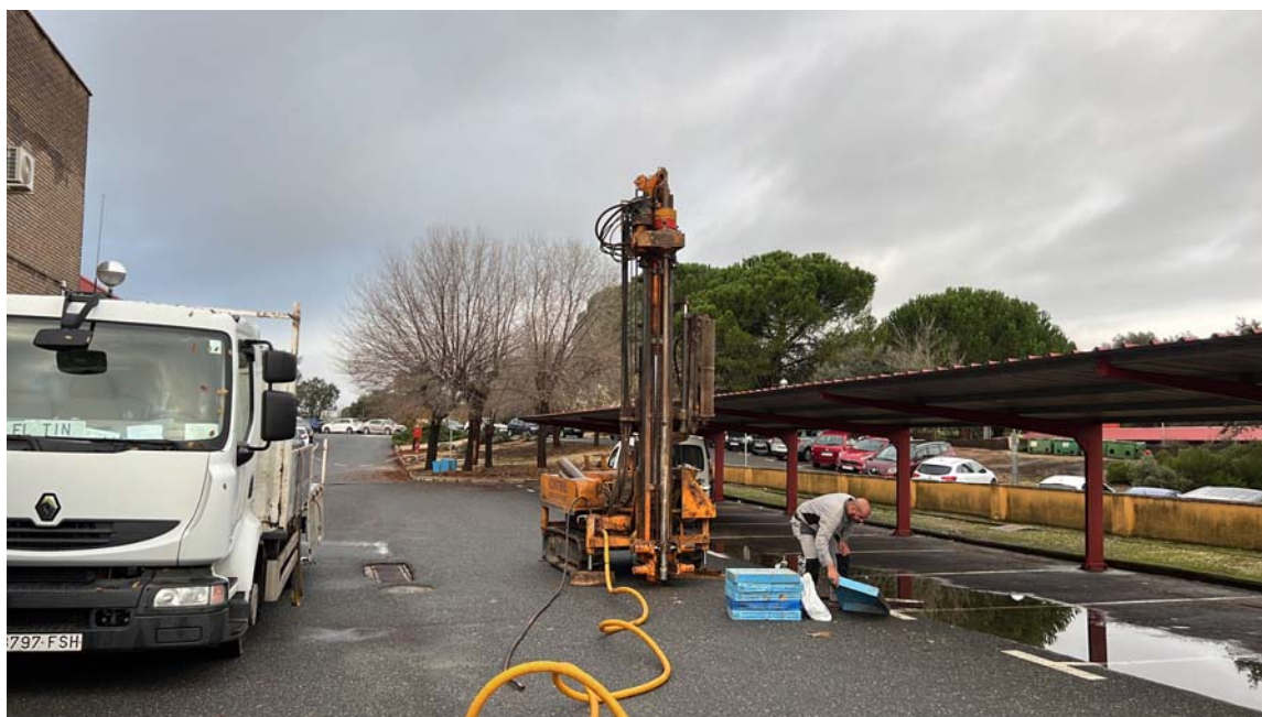
Sondeos con extracción de testigo continuo
